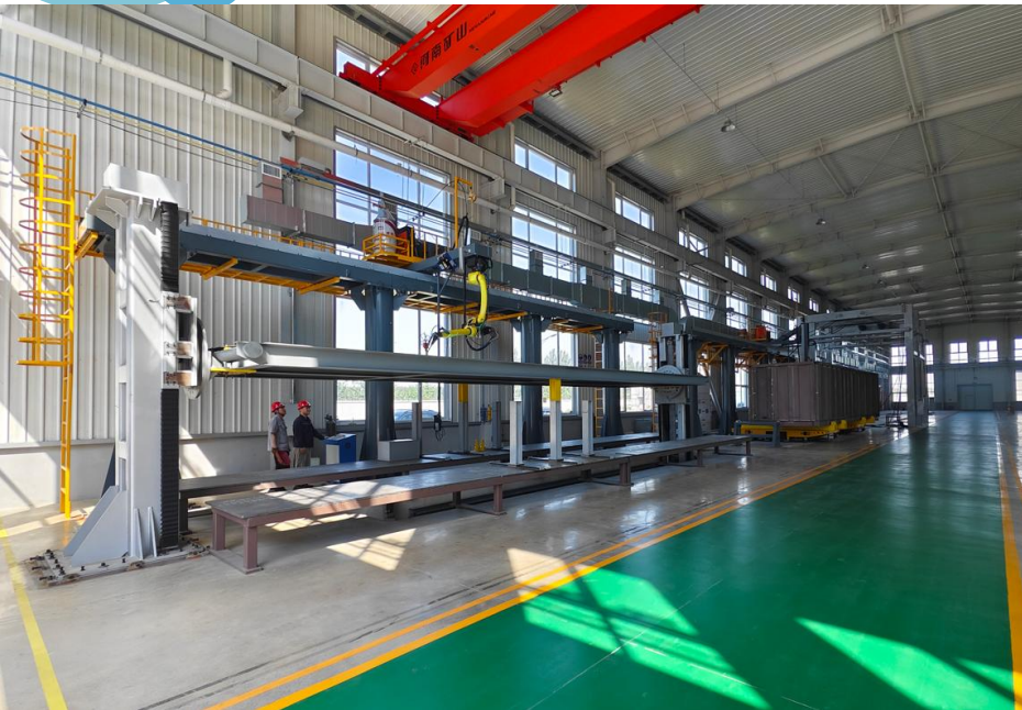
固控和分离设备机器人焊接生产线
